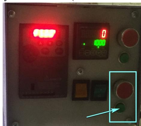
4.13 После замены шпули на валу намотки, левой педалью зажмите протяжный механизм полотна и запустите узел намотки, как указано в пп. 4.11. После того, как свободный конец полотна вышел достаточно для фиксации его на шпуле, отключите узел намотки нажатием красной клавиши, указанной в пп. 4.11. Зафиксируйте конец полотна на шпуле и отпустите педаль прижимного механизма.
