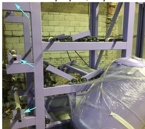
4.2 Для монтажа рулонов с защитной пленкой, необходимо снять вальцы с удерживающих металлических клипс, снять один из центрующих конусов, и просунуть вальцы через центральную ось рулонов. Одеть снятый конус и вернуть вальцы на посадочные места. Затем расположить рулоны таким образом, чтобы они были по центру производственной линии, а края пленок совпадали друг с другом. Закрепите рулоны центрующими конусами. Рекомендуется использовать пленку шириной 650 мм.
