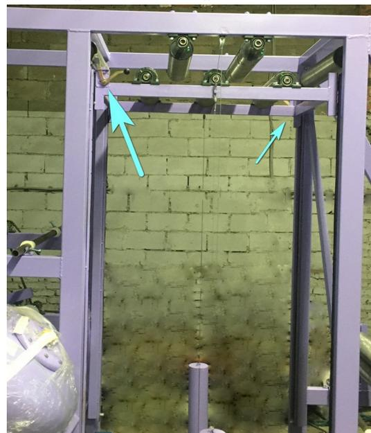
4.7 Протяните препрег в соответствии со схемой. В зависимости от расположения лицевых и внутренних сторон составляющих элементов «пирога» препрега, допускается изменение направления размотки рулонов. Защитную пленку, а также фольгу рекомендуется наносить непосредственно перед прохождением пропитанной основы препрега.
