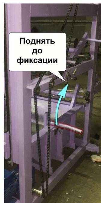
4.4 Снимите фиксирующие гайки регулировки толщины препрега с обеих сторон оборудования, чтобы исключить возможность травмирования конечностей.
