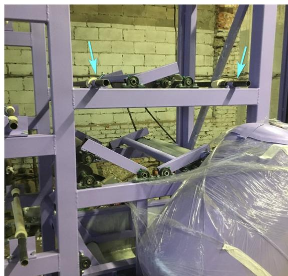
4.3 Для протяжки основы поднимите прижимной механизм пропиточной ванны в монтажное положение, освободив рукоять от нижнего фиксатора и поднять ее до момента надежной фиксации в верхнем положении.
