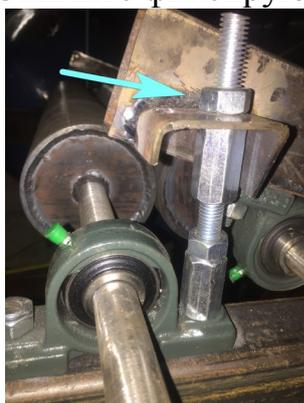
4.5 Запустите лентопротяжный механизм на малых оборотах (показания на табло привода не должны быть более 20,0), чтобы облегчить операторам дальнейшую протяжку препрега. После протяжки через приводные валы, аккуратно, без рывков и резких отпусканий, верните рукоять прижима ванны в рабочее (нижнее) положение.
